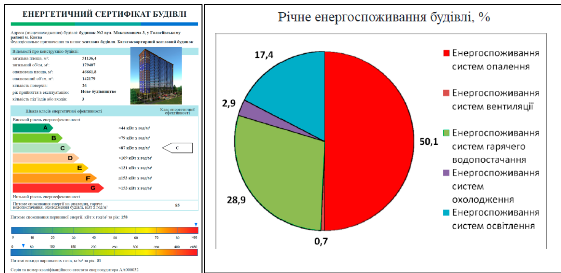
Рис. 2. Сертифікат житлової будівлі. Діаграма річного енергоспоживання будівлі
