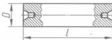
2 етап. Виконано елемент, що має циліндричну поверхню з діаметром  $D$ , і довжиною  $l_1$ .
