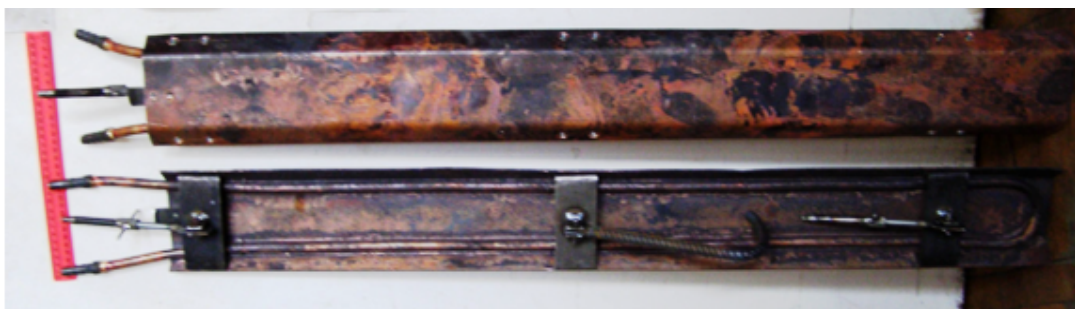
Рис. 3. Зовнішній вигляд пристроїв для формування зварних швів у важкодоступних ділянках товстостінних металоконструкцій.
